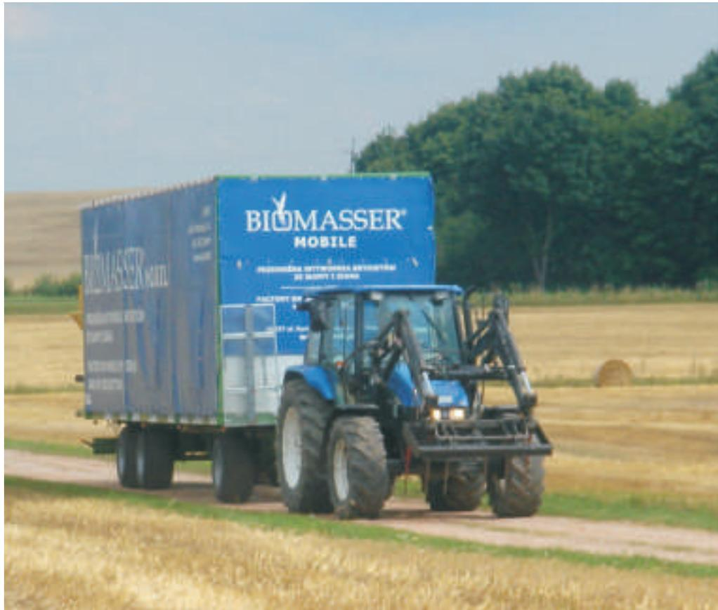
BIOMASSER® MOBILE sind mobile Produktionslinien, die an den Rohstofflagerort fahren. Somit können die Kosten des Strohtransportes an den Ort, an dem die Brikett Herstellung stattfindet, eliminiert werden.
